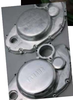
←↑微妙な力加減が要求されるバフ掛け。クランクケースの表面にある厚み30ミクロンの層で磨きを仕上げなければならぬ。左の写真は上が施工前で下が施工後
