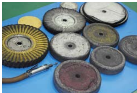
↑スペシャルバフ掛けの行程では、180番から280番まで5種類のバフ材を使って磨き。さらに3種類のバフで鏡面に仕上げ。通常のバフ掛けでも5種類バフを使う
