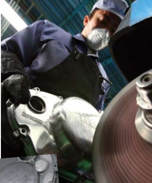
←↑微妙な力加減が要求されるバフ掛け。クランクケースの表面にある厚み30ミクロンの層で磨きを仕上げなければならぬ。左の写真は上が施工前で下が施工後
