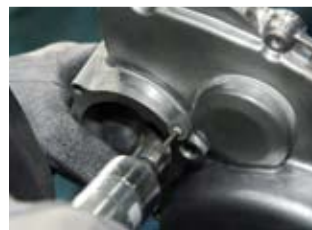
↓まずリユーターというエアツールでクランクケースの細かい奥まった部分を荒めの研磨剤で磨く
