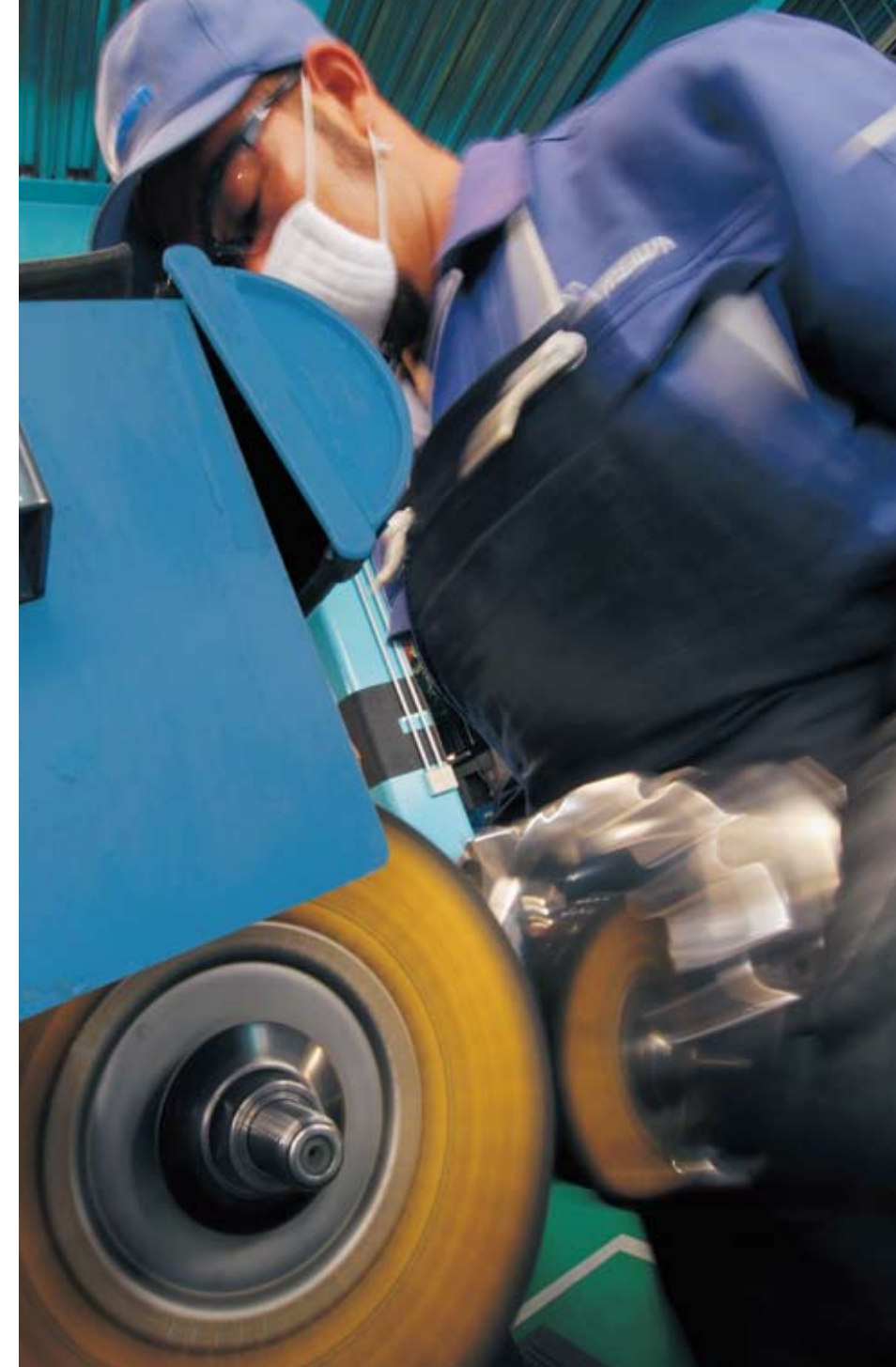
▲高速回転するバフにワークを押し当てて磨き込むという、典型的なバフ研磨の作業風景。ワークを持つ手が左右に揺れているが、作業員の頭がほとんどブレていないことに注目。
